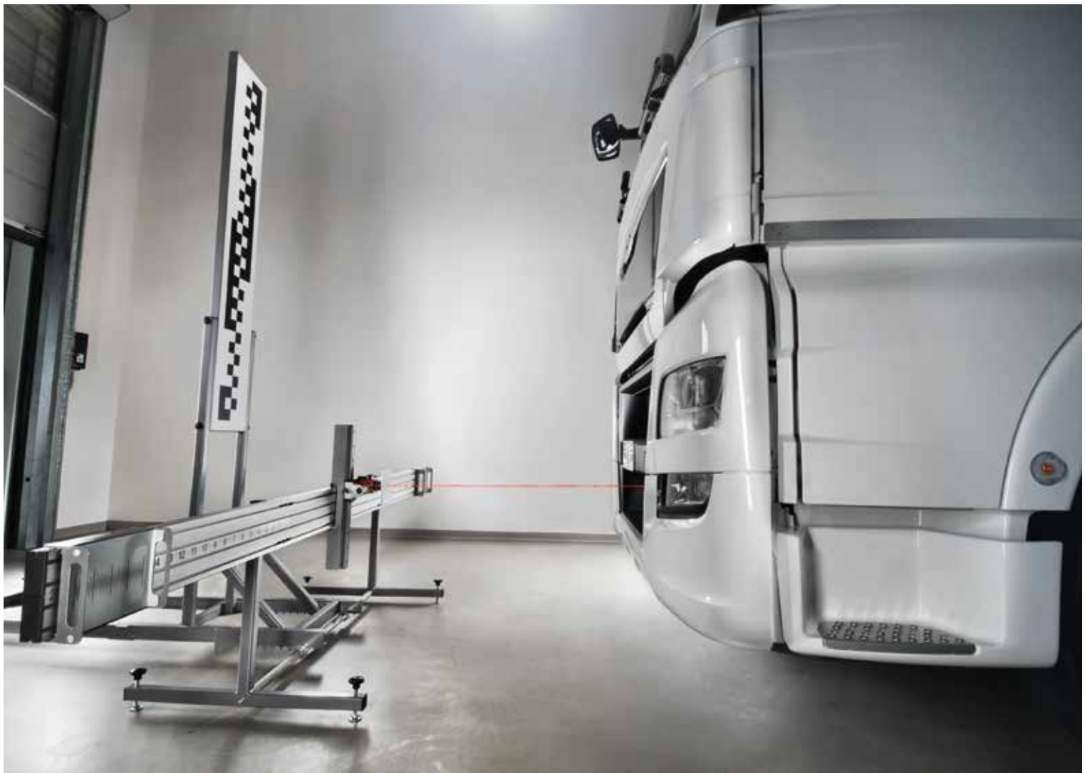
Scala graduata magnetica per controllo allineamento telaio
